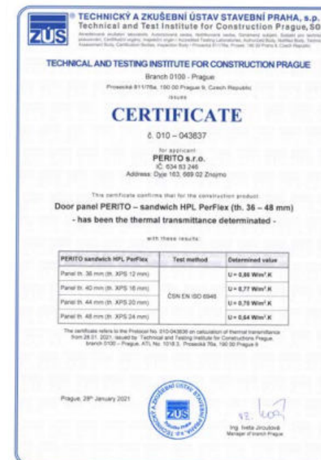
Certificat des panneaux de portes en HPL avec âme PerFlex - coefficient de transmission thermique
