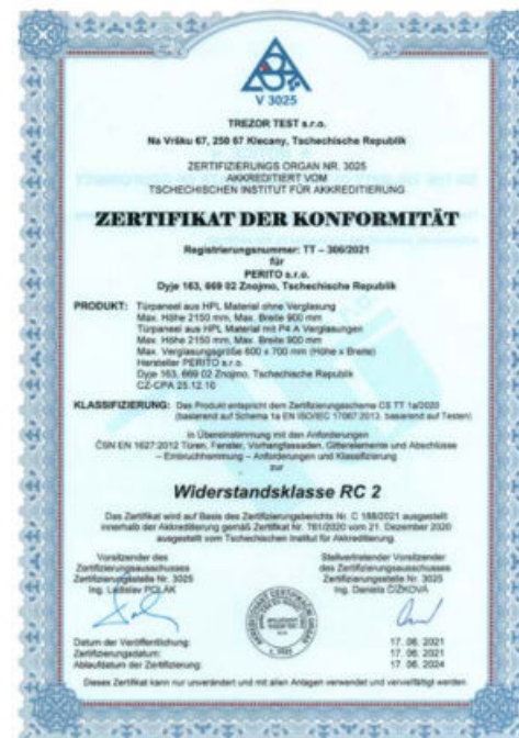
Certificat de classe de sécurité (RC2) pour panneaux de porte HPL
