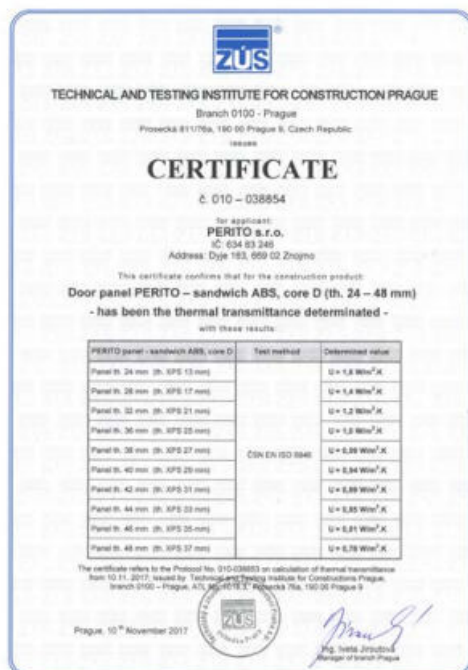
Certificat des panneaux de portes en ABS avec âme D - coefficient de transmission thermique
