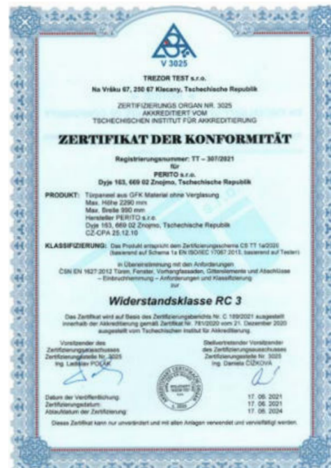
Certificat de classe de sécurité (RC3) pour panneaux de porte GFK (non vitrés)
