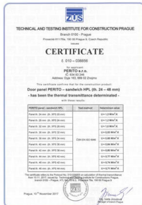
Certificat des panneaux de portes en HPL - coefficient de transmission thermique
