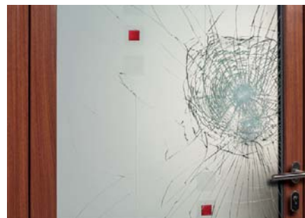
Vue depuis l'extérieur – film PVB empêchant le passage à travers le panneau de verre
